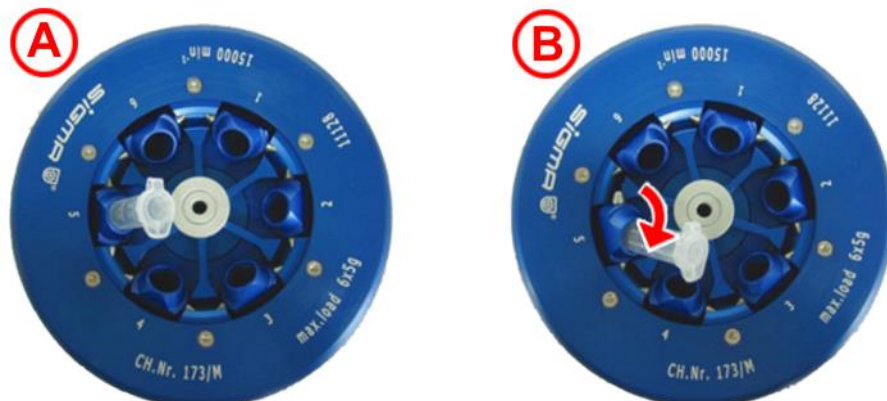
Abb. 8: Einsetzen von großen Gefäßen
