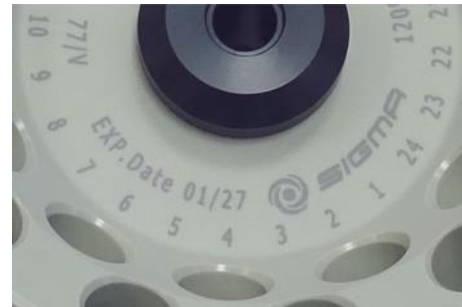
Abb. 4: abweichende Lebensdauer – Gravur auf dem Becher / Rotor
