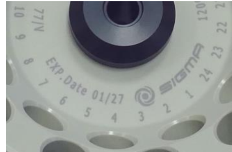
Abb. 4: abweichende Lebensdauer – Gravur auf dem Becher / Rotor
