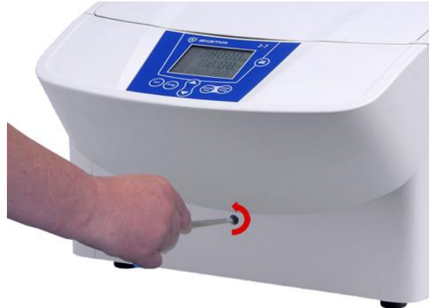
Abb. 11: Manuelle Entriegelung des Deckelschlosses
