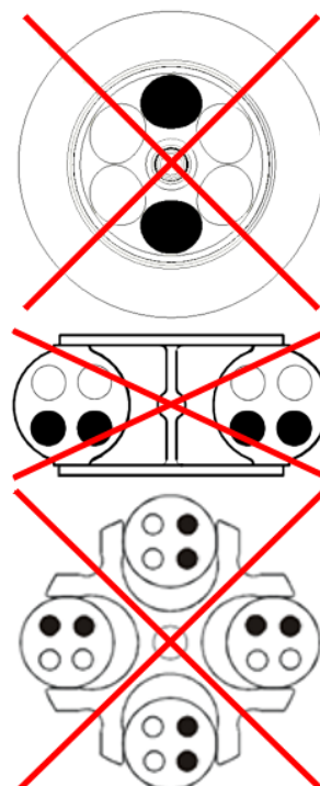
Abb. 6: Zulässige und unzulässige Beladung von Winkel- und Ausschwingrotoren (Beispiele)
