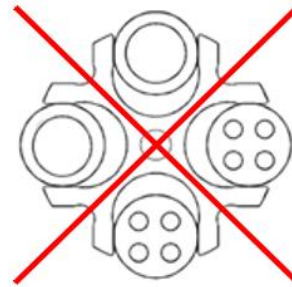
Abb. 5: Zulässige und unzulässige Beladung des Ausschwingrotors mit unterschiedlichen Gläsergrößen (Beispiele)
