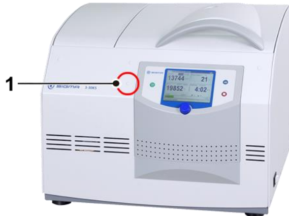
Abb. 30: Position der Öffnung für die Notentriegelung
