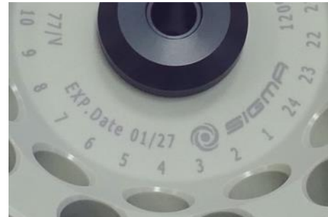
Abb. 4: abweichende Lebensdauer – Gravur auf dem Becher / Rotor
