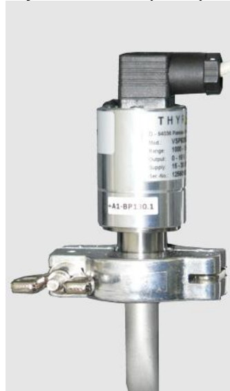
Abb. 12: Vakuummesssonden verschiedener Hersteller
